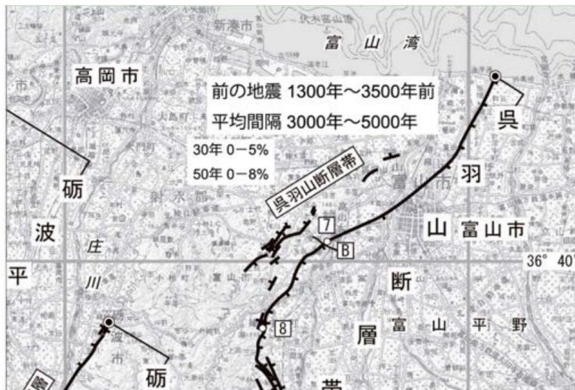
図3 地震調査委員会の活断層評価「砺波平野断層帯・呉羽山断層帯の長期評価の一部改訂について」(2008)の図3から呉羽山断層帯の部分を取り出し、評価の一部の数字を加筆した。
