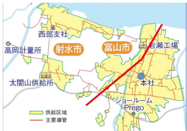
図9 基図は日本海ガスの導管分布図（日本海ガスのHPによる）。赤実線は呉羽山断層のおよその位置。
