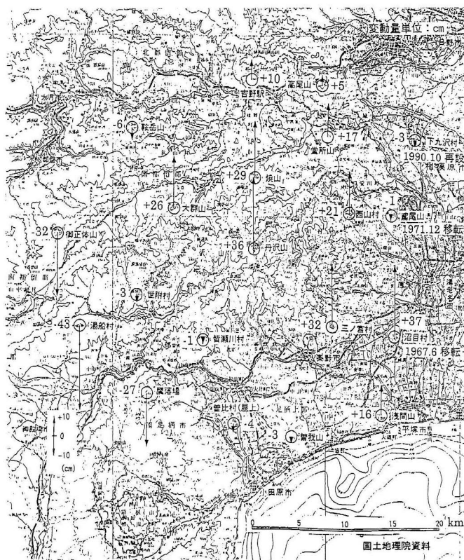
図4 丹沢地区の三角点の標高変化(1996~1925) 1996年:高度基準点測量成果,1925年:関東震災復旧測量(第124回:地理院)
