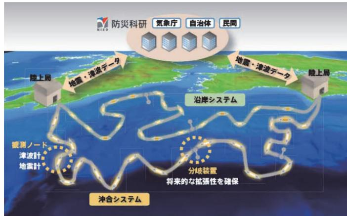
図 1 南海トラフ海底地震津波観測網 N-net のイメージ図
