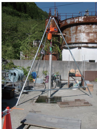
図 6 跡津川断層測定におけるボアホール挿入直前の検出器、およびそれを固定する三脚の外観
